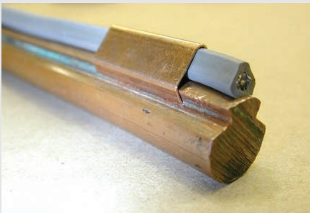
Le système nVent RAYCHEM CATHeat comprend une gaine en polymère fluoré haute température, une gaine extérieure en silicone thermoconducteur et des clips de fixation en bronze phos
