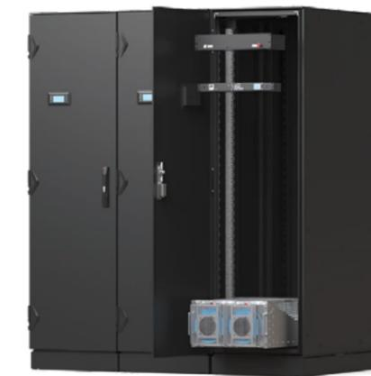
针对高精度的测试测量、高能物理等应用对于恒温运行、高效冷却等的要求, 我们为Varistar CP机柜配置了模块化的水冷热交换器, 采用19"标准冷却模块, 可轻松集成至机柜内。在满足散热需求的同时提供最高+/- 0.1°C的精密控温。
