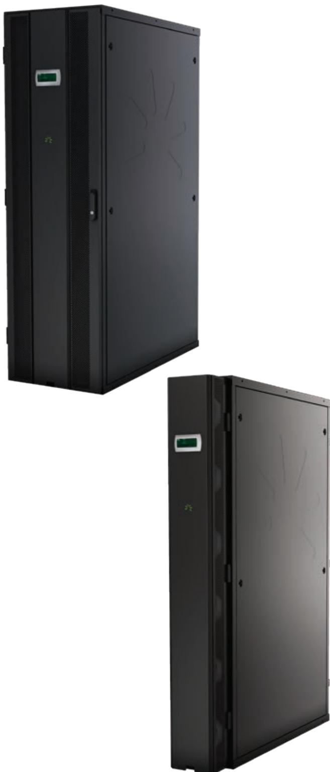
L'échangeur thermique air/eau nVent SCHROFF **RackChiller In Row** est conçu pour gérer les exigences de refroidissement critiques des baies serveur et réseau. L'ensemble du système est hébergé dans une unité séparée et intégré dans une rangée de baies serveurs fermées. Les ventilateurs actifs déplacent l'air chaud évacué des serveurs à travers un échangeur thermique air/eau et la chaleur est transférée vers un circuit d'eau. Les ventilateurs alimentent l'équipement en air refroidi.
