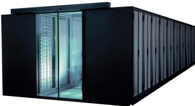
Eine Einblastemperatur von 12,6 °C am Umluftklimagerät ist notwendig, um die im oberen Schrankbereich montierten Server mit 25,6 °C kalter Luft zu versorgen. Dies hat eine nVent-Analyse von Kalt- und Warmgangaufstellungen gezeigt.
