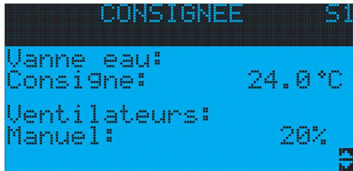
Permet de configurer la consigne pour le réglage de la vanne d'eau. Si la régulation s'effectue par l'intermédiaire d'un capteur de température, la température est définie soit en °C ou en °F, l'ouverture de la vanne d'eau est définie en %.
