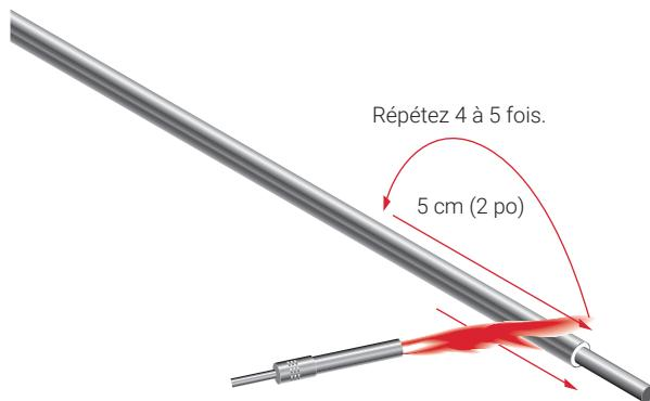
Il peut être nécessaire de recommencer la procédure ci-dessus plusieurs fois pour éliminer totalement toute l'humidité du câble. Laissez le câble refroidir avant de recommencer.
