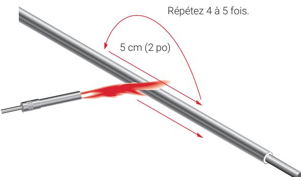
Déplacez progressivement la flamme vers l'extrémité tout en effectuant de petits mouvements de balayage de la torche. Si vous chauffez trop rapidement vers l'extrémité du câble, vous pourriez laisser passer de l'humidité et l'amener vers le câble.
