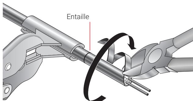
Continuez de retirer la gaine sur l'entaille de repérage. Lorsque vous êtes sur le point de couper dans l'entaille, placez la pince coupante latérale à angle droit avec le câble. Terminez en plaçant le point de pince coupante latérale de façon parallèle au câble. La gaine se décolle en révélant une coupe propre lorsque l'entaille de repérage est atteint.
