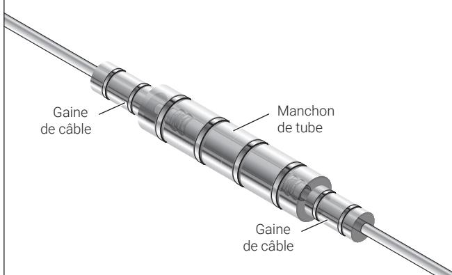
**Remarque :** Ne centrez pas le manchon du tube sur le tube à épissure, ce qui laisserait un espace dégrade le classement au feu de l'épissure.
