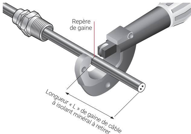
Saisissez le câble au moyen de l'outil Handvise derrière l'entaille effectuée sur la gaine. Saisissez le bord de la gaine entre les mâchoires de la pince coupante latérale et tournez dans le sens des aiguilles (tournez dans le sens inverse des aiguilles si vous êtes gaucher), puis effectuez une nouvelle prise et tournez d'un petit angle.
