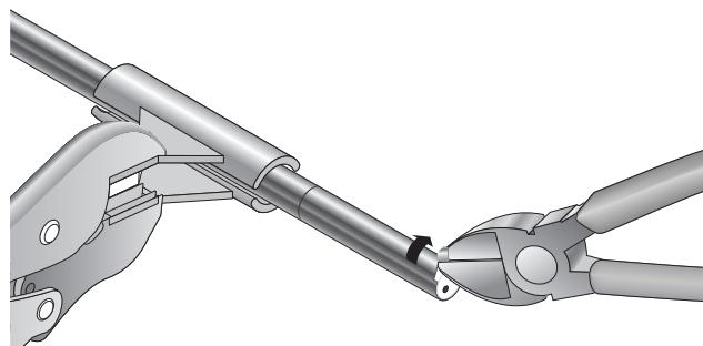
Continuez d'effectuer ce mouvement dans une série de dénudages courts, en gardant la pince coupante à environ 45° de la ligne du câble, et en retirant la gaine dans un mouvement en spirale. Retirez l'isolation en poudre compacte pour exposer les conducteurs.
