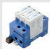
Os SPD's montados nos trilhos DIN, incluindo os modelos de supressores shunt e os filtros série, fornecem vários níveis de proteção contra sobretensões em linhas de energia sendo fáceis de montar e instalar em trilhos DIN de 35 mm.
